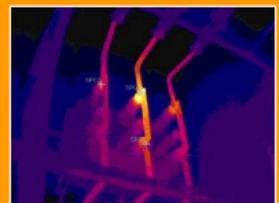
Übergangswiderstände führen hier durch Umsetzung elektrischer Leistung in Wärme zu Temperaturerhöhungen, die problemlos erkannt und meist **eindeutig** beurteilt werden können.
